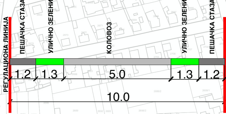
ПОПРЕЧНИ ПРОФИЛ ПЕШАЧКИ ПРОЛАЗ X-X ПОПРЕЧНИ ПРОФИЛ ПРИСТУПНЕ САОБРАЋАЈНИЦЕ XIII-XIII
